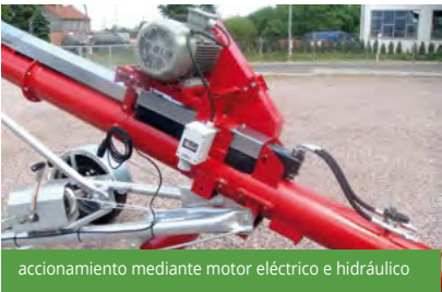
accionamiento mediante motor eléctrico e hidráulico
