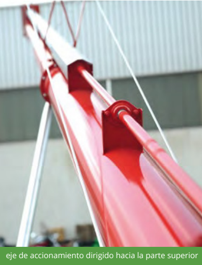
eje de accionamiento dirigido hacia la parte superior
