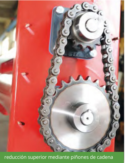
reducción superior mediante piñones de cadena
